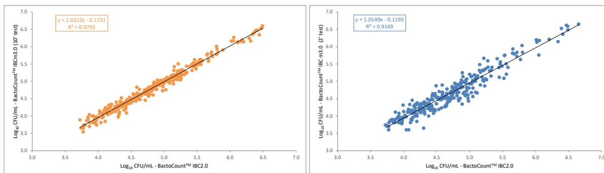
Figure 3 : Relation entre les résultats du BactoCount™ IBCm3.0 et du BactoCount™ IBC2.0 pour les TBC (● test 10' ● test 2')
