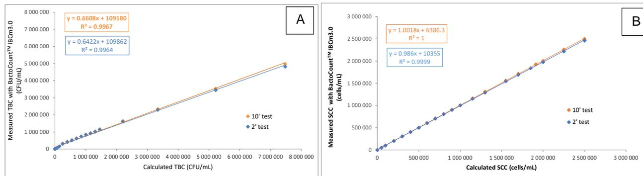
Figure 2 : Linéarité du BactoCount™ IBCm3.0 pour la mesure des TBC (A) et SCC (B)
