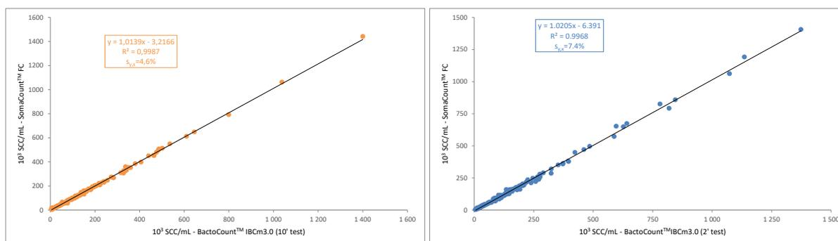
Figure 4 : Relation entre les résultats du BactoCount™ IBCm3.0 et du SomaCount™ FC pour les SCC (● test 10' ● test 2')
